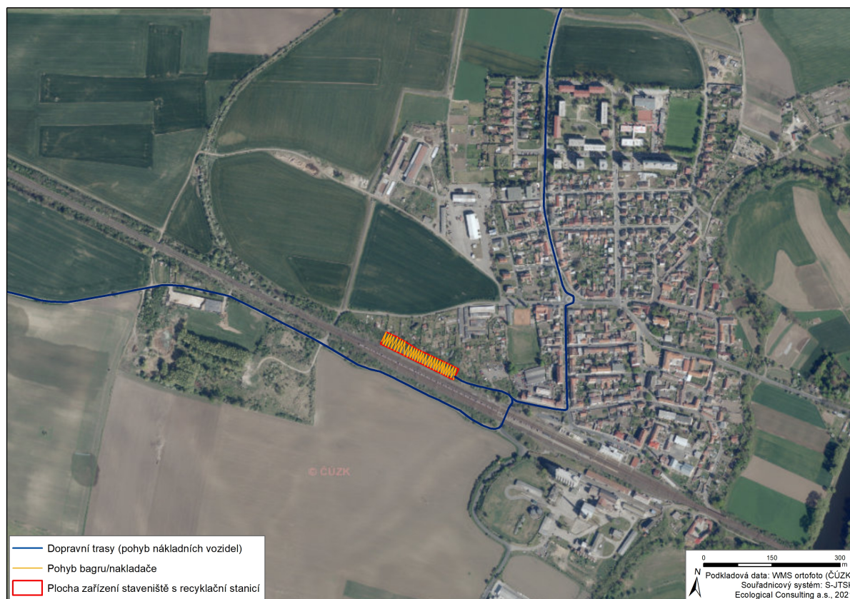
Obr. 5: Vymezení liniového zdroje, tzn. trasy pro dopravu materiálu nákladními vozidly (modrá linie), pohyb bagru/nakladače (oranžová linie), červený polygon znázorňuje plochu zařízení staveniště s recyklační stanicí
